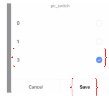
11. Vælg nu "pir_switch". Sæt til 0, hvis kamera ikke skal optage. Sæt til max - enten 3 eller 10 (det afhænger af kameraversion), hvis kamera skal optage. Tryk "Save".
