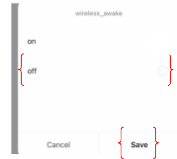
10. Vælg "Off", for at indstille kameraet til at slukke og ikke optage ved frakobling af alarm. Tryk "Save".
